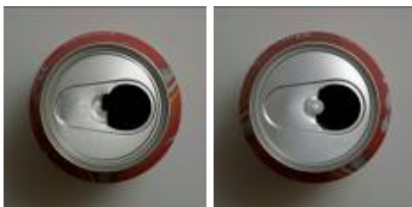
Fig. 11 : rivet arraché Figure 12 : levier détaché
